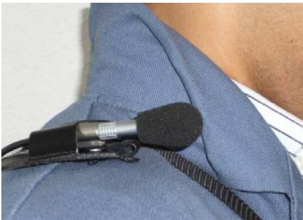
Foto 1 en 2 Plaatsing microfoon (links) en dosimeterkastje (rechts) voor geluidbelastingmetingen (Acoemgroep, 2014).
