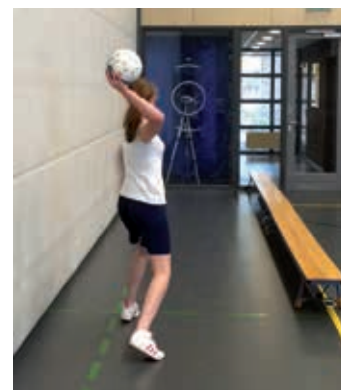
Figuur 2. Meetinstrument. Met één cirkel en een aantal ijkpunten op de glaswand, een snelheidsmeter 80 cm achter de glaswand en achter de camera een rustgevend scherm.
