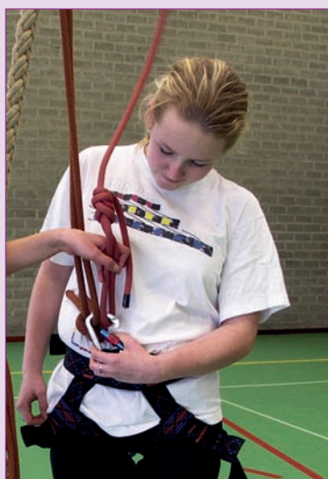
Zekertouw wordt bevestigd in de karabiner
